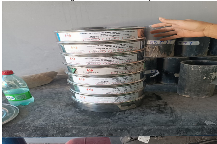
Figura 4. Início do ensaio de granulometria com as peneiras
