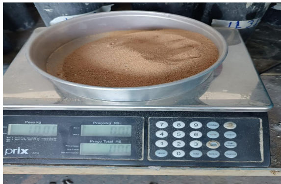
Figura 3. Pesagem das amostra do agregado miúdo.
