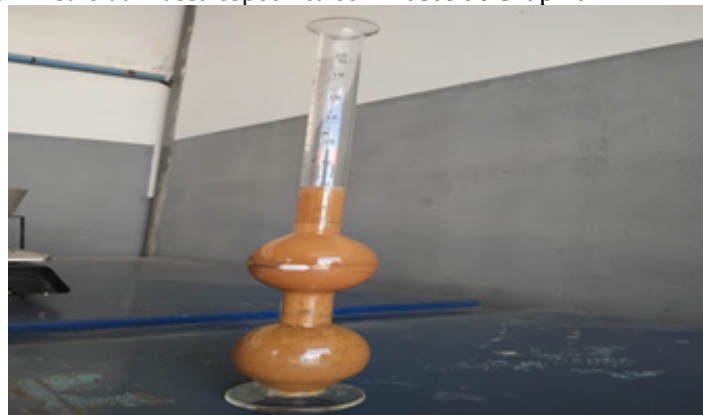
Figura 5. Ensaio da massa específica com frasco de Chapman.
