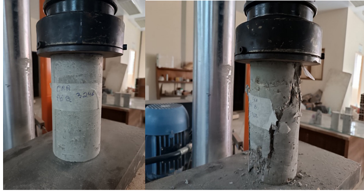
Figura 6. CP traço com pó de brita em rompimento
