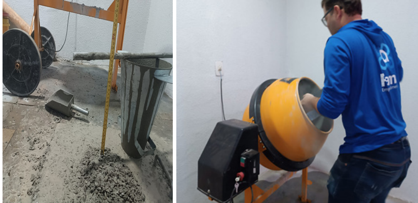
Figura 2. mistura de material e Ensaio de espalhamento (slump flow test).
