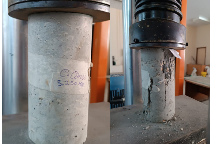
Figura 5. CP traço convencional em rompimento.
