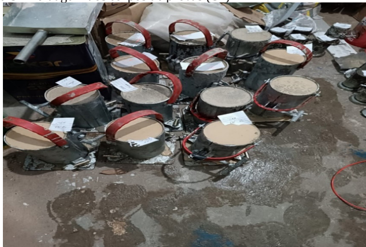
Figura 3. Moldagem dos corpos de provas (CP).
