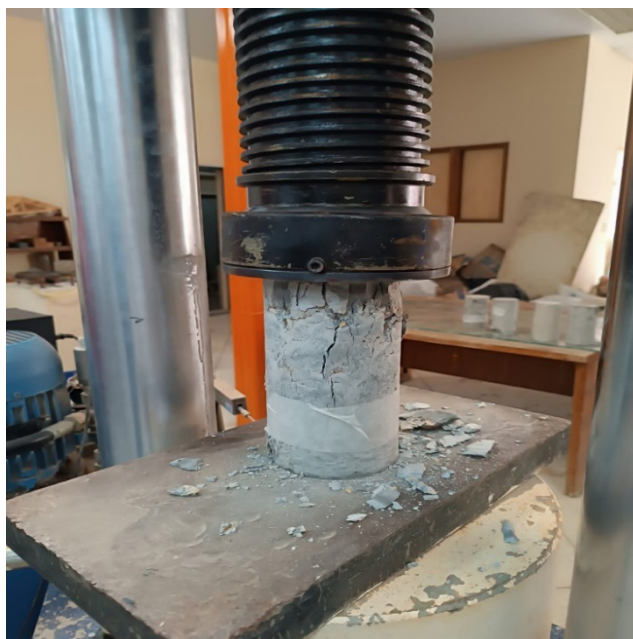
Figura 4. Ensaio de compressão
