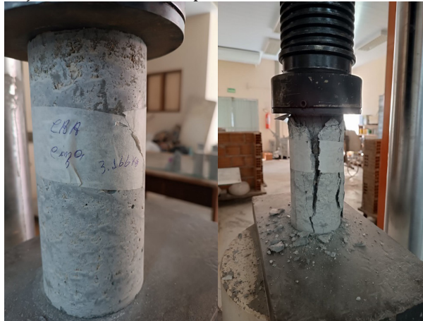
Figura 7. CP traço com cinza em rompimento.
