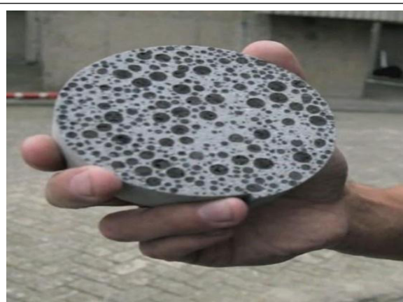
Figura 7. Bioconcreto com capacidade de autorregeneração
