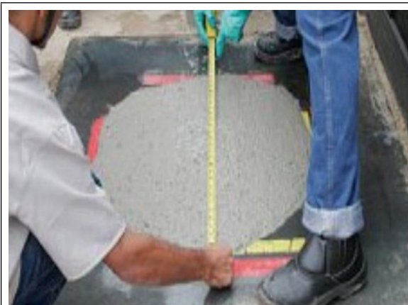
Figura 2. Concreto com filler de pó de calcário
