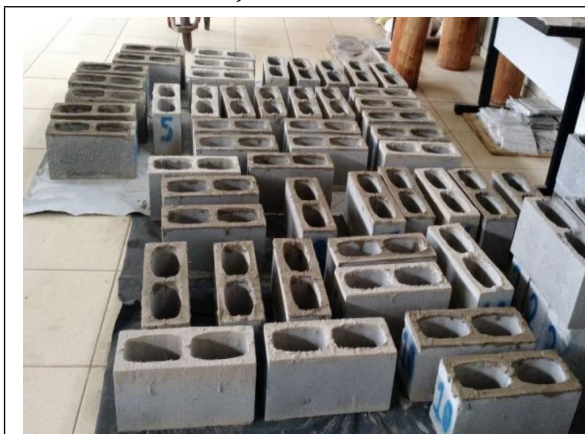
Figura 4. Produção de bloco de concreto com resíduos de mineração e fibra de coco
