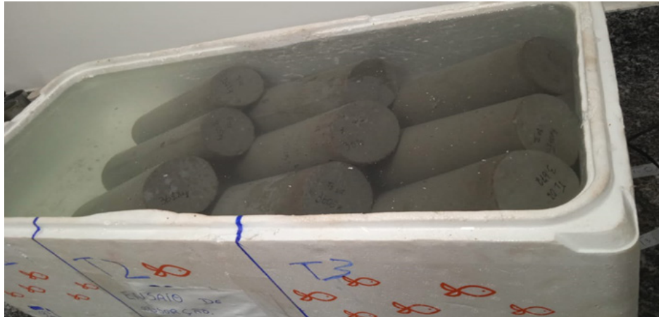
Figura 6. CP para ensaio de absorção
